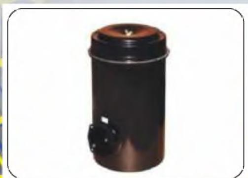
Запасные части для автомобилей МАЗ. Расход воздуха 1660 м<sup>3</sup>/ч, Ø410мм, h725мм. Без клапана для слива конденсата. Без фильтрующего элемента.
